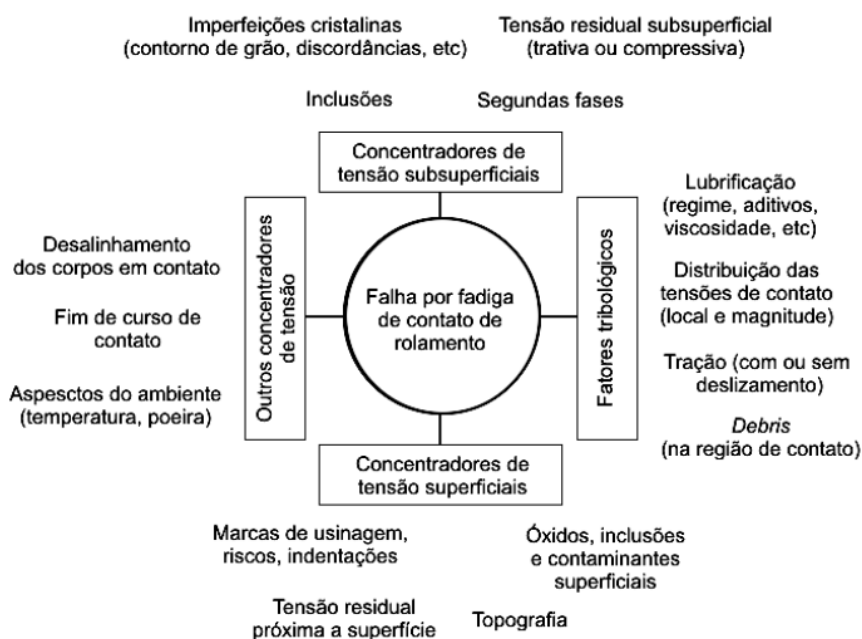
Figura 1: Fatores que afetam a vida em fadiga de contato. (4)
