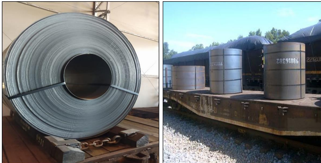
Figura 4. Bobina Carregada na Posição Horizontal com Utilização de Dormentes (esquerda) e Bobina Carregada na Posição Vertical sem Utilização de Dormentes (direita)
