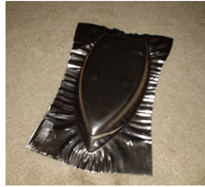
Figura 11. Peça exemplo estampada com aço inoxidável AISI 430-E2.
