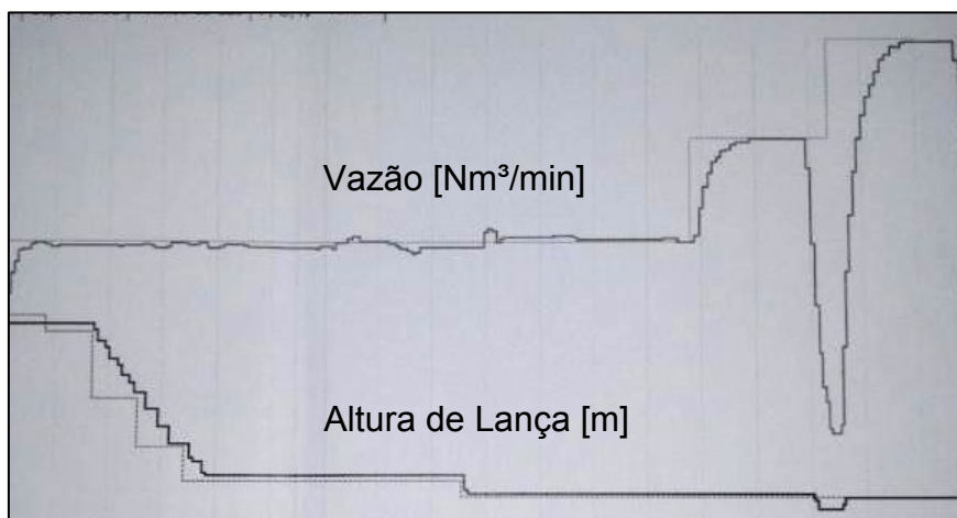
Figure 11: Parâmetros programados e realizados do perfil de sopro: vazão de oxigênio e altura de lança.
