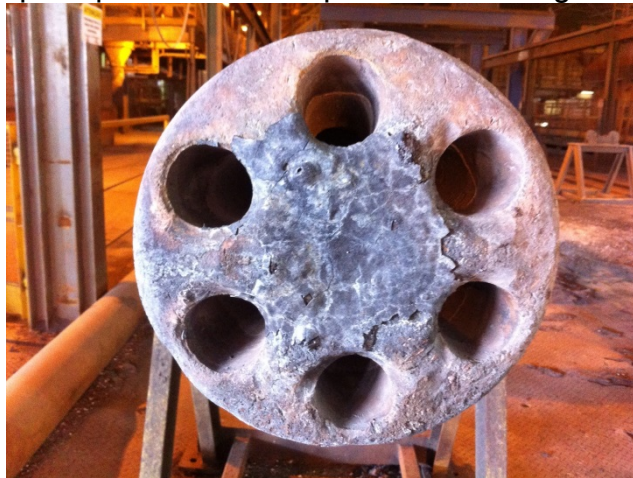
Figure 03: Face do cartucho após uso.
