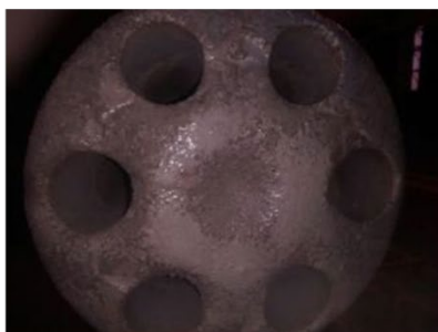
Figure 09: Redimensionamento dos bocais e aspecto da face do cartucho com a evolução no número de corridas.
