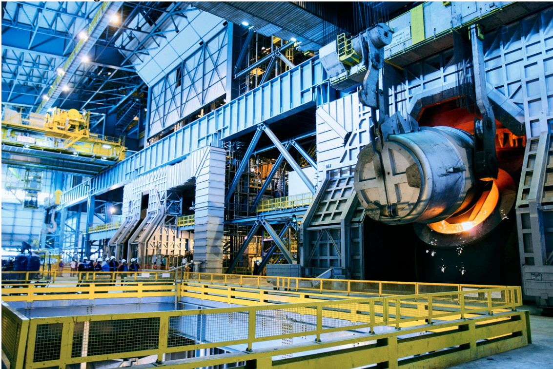
Figure 01: Carregamento de gusa no convertedor 2 da Ternium Brasil (330 ton).
