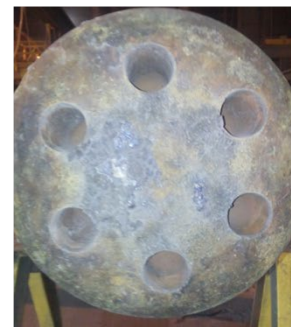
Figure 09: Redimensionamento dos bocais e aspecto da face do cartucho com a evolução no número de corridas.
