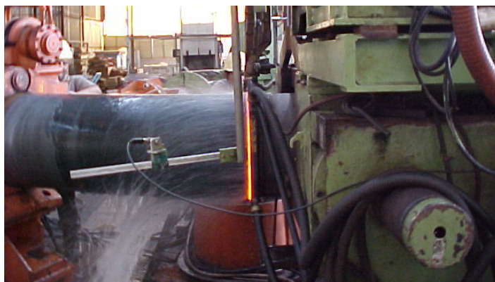
Figura 2. Curvamento por indução do X80.
