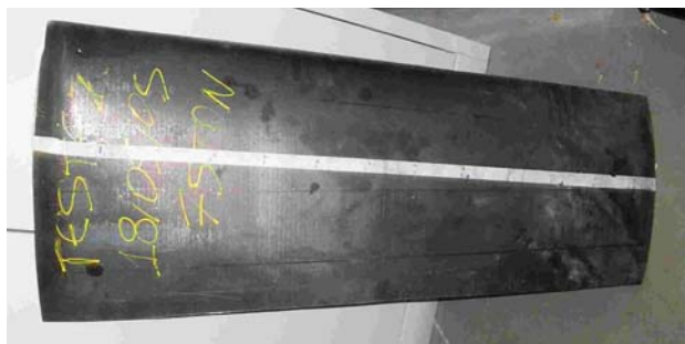
Figura 3. Corte final da Chapa 2 para medição dimensional. (3)
