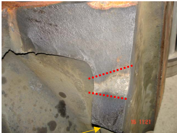
Figura 4. Detalhe da superfície de fratura, próximo a região de início. A região entre as linhas pontilhadas foi alterada pela operação de corte.
