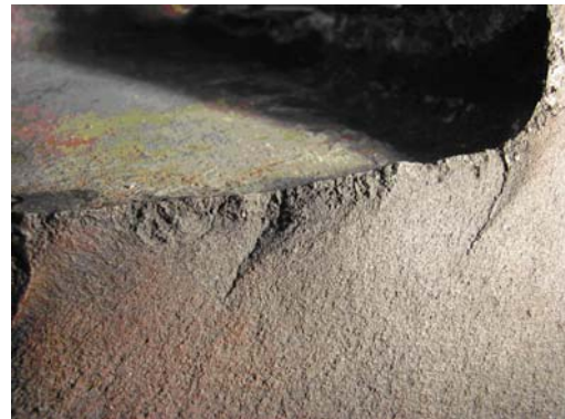
(B) Camada alterada ao longo da superfície do lado interno. Não se observa camada ao longo do lado externo. (C) Detalhe da camada alterada da superfície interna.
