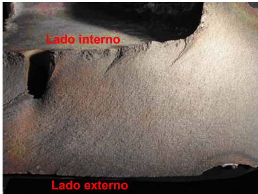
(B) Camada alterada ao longo da superfície do lado interno. Não se observa camada ao longo do lado externo. (C) Detalhe da camada alterada da superfície interna.
