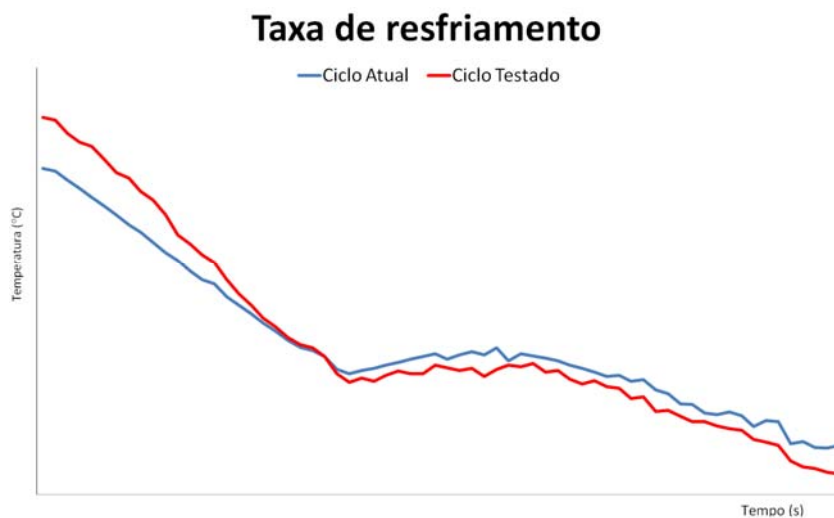
Figura 10. Taxa de resfriamento do Protendido no ciclo atual (azul) e no ciclo testado (vermelho).
