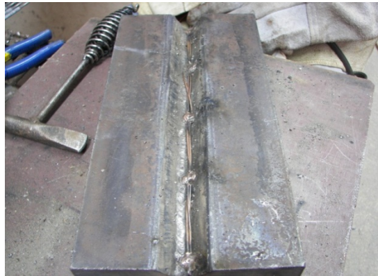
Figura 3: Corpos de prova, mostrando a colocação de fios de cobre no chanfro.
