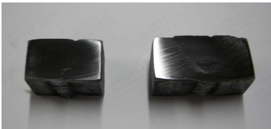
Figura 6: Corpos de prova submetidos à soldagem com inclusão de cobre após cortados e lixados para a análise metalográfica.
