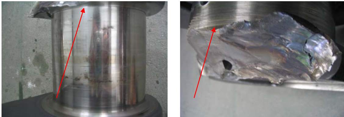
Figura 7. Defeito de usinagem apresentado no eixo de virabrequim evidenciado pela seta.
