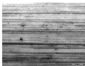
(d) Cilindro #4 Inferior Rug. Ra: 10,7 μinch
