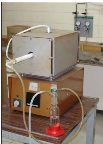
Figura 3: Forno tubular com o aparato de Perda ao Hidrogênio acoplado, ao fundo, detalhe para as válvulas de injeção dos gases, e a frente, o lavador de gases.
