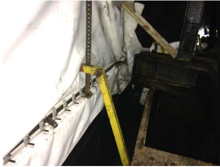
Figura 10. Dispositivo para montagem da nova selagem
