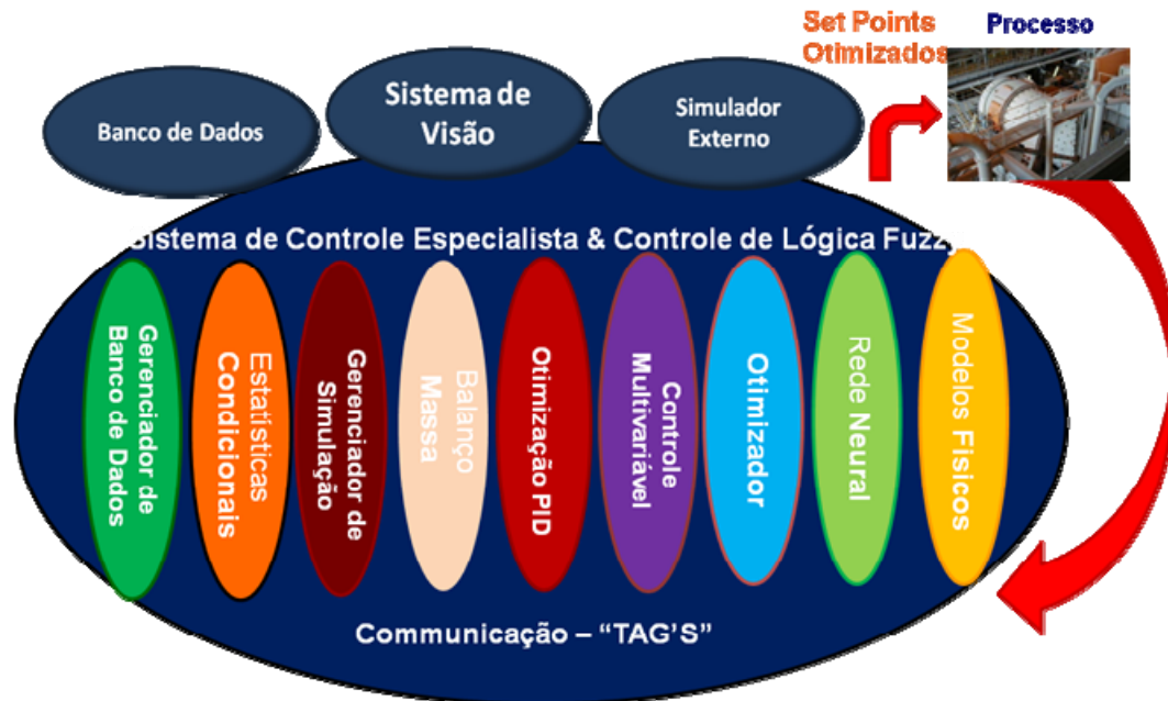
Figura 3 – Estrutura modular do sistema.
