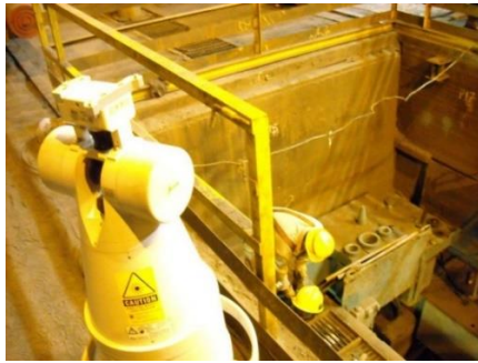
Fig. 2.6 – Posicionamento do tracker na parte superior da máquina (Fonte: acervo do autor)
