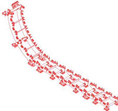
Fig. 2.2 – Desenho da viga banana da máquina de lingotamento de placas (Fonte: acervo do autor).
