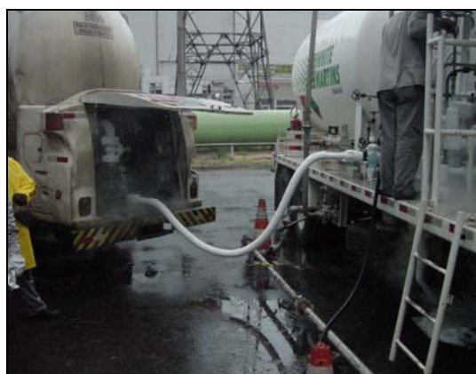
Figura 18 – Recarregando da Carreta;
