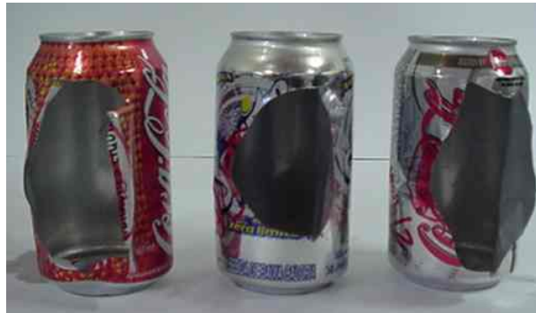
Figura 7. Perfil de fratura do vaso de pressão com trinca única (primeira lata à esquerda) e múltiplo (a lata do meio e a da direita com duas e três trincas adjacentes respectivamente).
