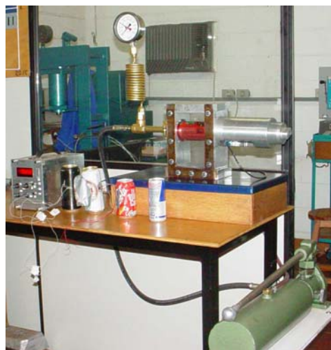
Figura 5. Aparato experimental para ensaio de vasos de pressão cilíndrico sujeito à pressão hidrostática interna.
