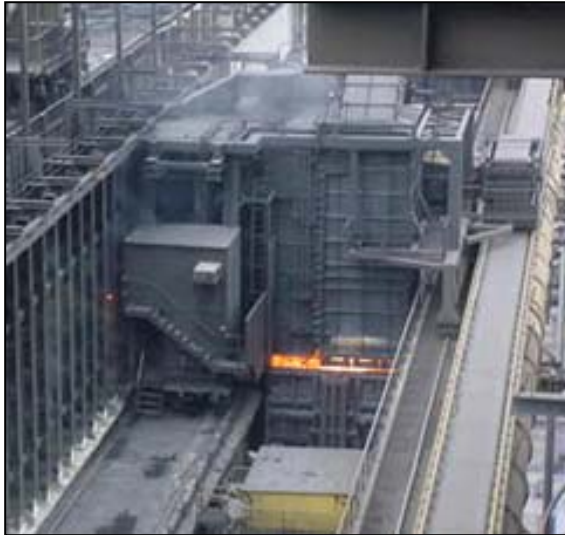
Figura 3. Sistema de despoejamento do desenformamento de coque
