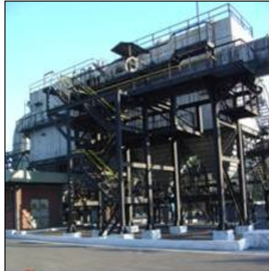
Figura 3. Sistema de despoejamento do desenformamento de coque
