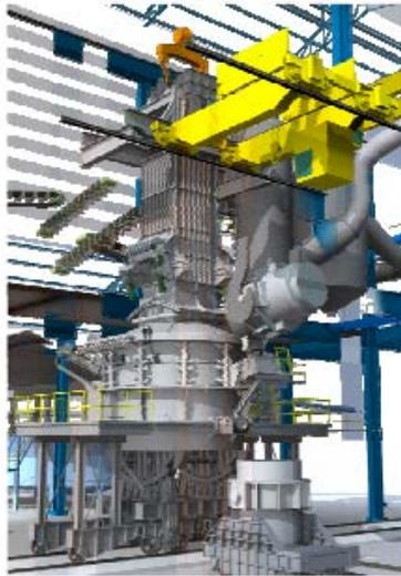
**Figura 4-** Vista do EOF que opera sem eletrodo e sem energia elétrica. Somente HM e sucata aquecida com os gases do próprio forno. <sup>(7,8)</sup>
