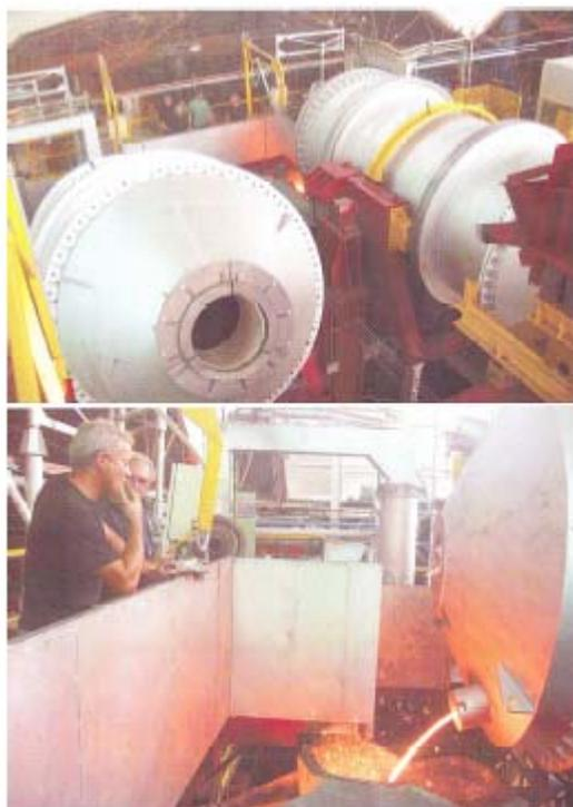
**Figura 2** – Vista em operação da Bateria 2, fornos Oxigas de 30 t, numa fundição Italiana de FoFo Nodular.<sup>(3)</sup>
