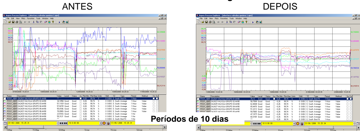
Figura 15. Comparativo das aberturas de válvulas de gás antes e depois dos trabalhos de otimização.
