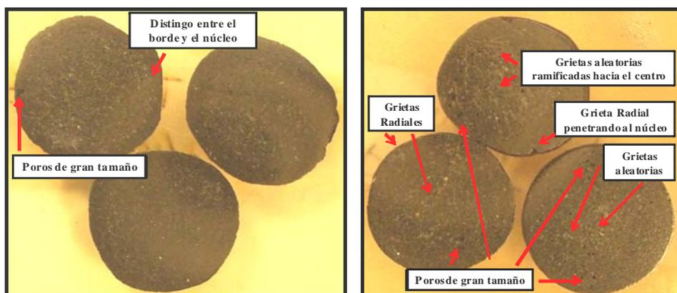
**Figura 3.** Macroscopias de pellas de la pila 3. A) Planta. B) Laboratorio.
