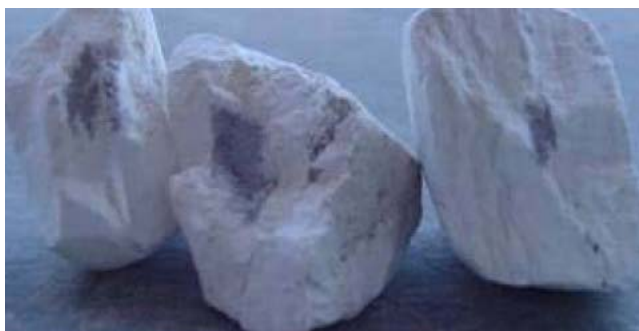
Figura 1. Pedra de cal virgem com núcleo de carbonato não dissociado.
