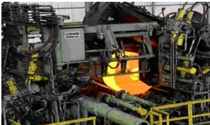
**Figura 3.** Bobina de esboço sendo processada no coilbox
