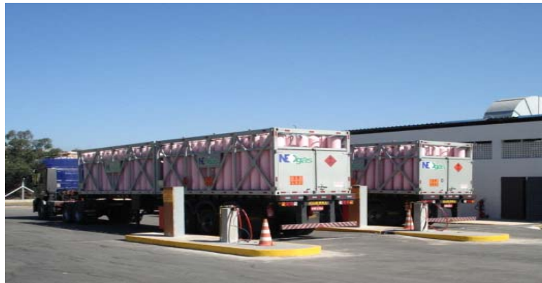
Figura 2. Unidades de compressão de GNC da Neogás em Betim
