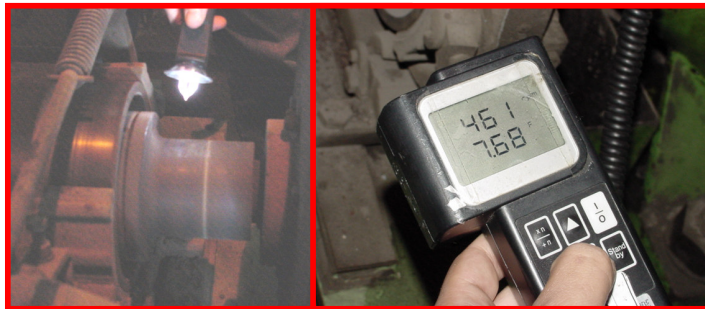
Figura 12. Medição de velocidade executada pelo técnico de inspeção.
