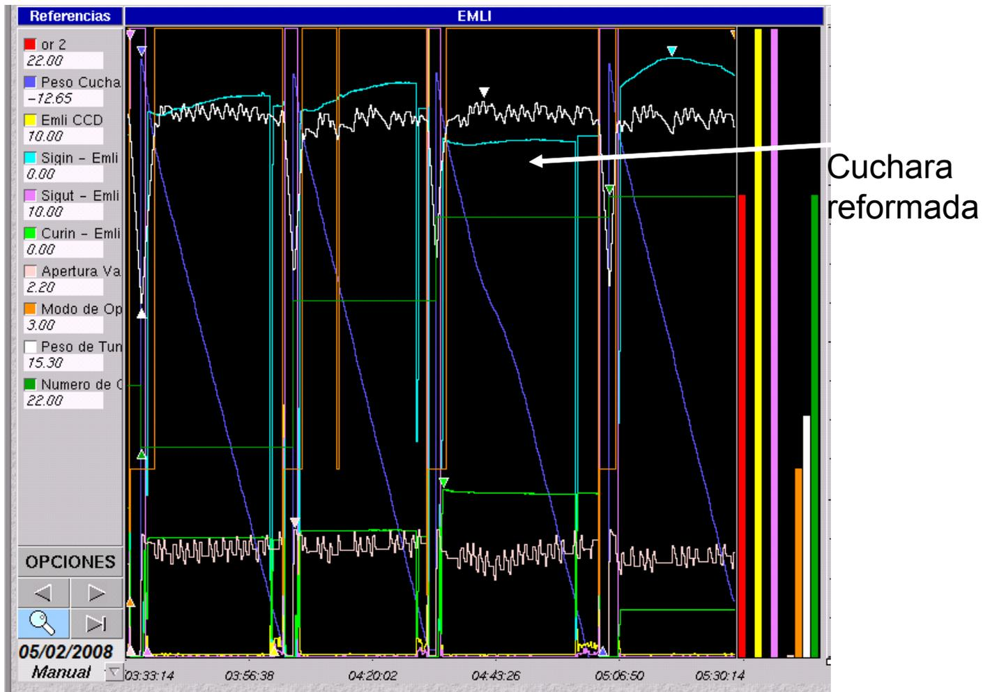
Este ciclo de reformas de las cucharas de acero SIDERAR, iniciado en agosto del año 2005 con la cuchara N° 15, nos permitió ir optimizando los desarrollos de los nuevos sensores con el proveedor MPC, la mecánica de reemplazo de la placa base con proveedor de la válvula de control INTERSTOP y el ajuste de los parámetros del sistema de detección instalado en la CCD con correlación según cuchara en tránsito
