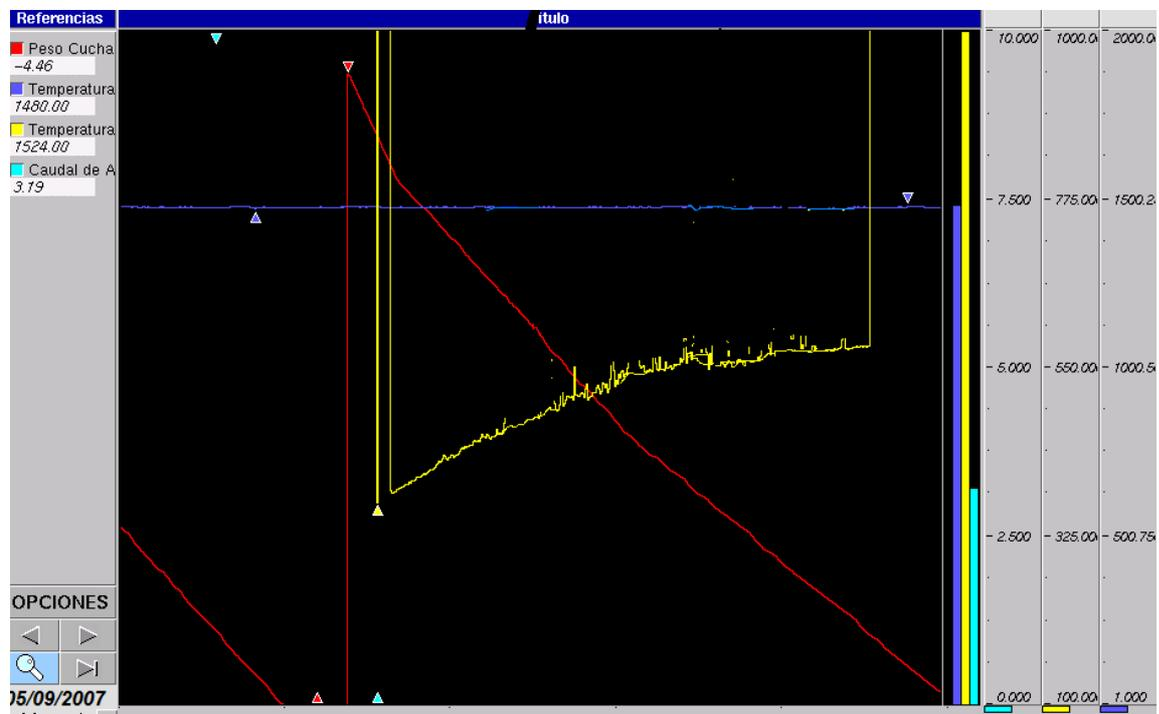
La grafica de temperatura en color amarillo inicia en 300° C cuando se abre la válvula de cuchara y Se incrementa hasta 530 °C cuando finaliza el colado.
