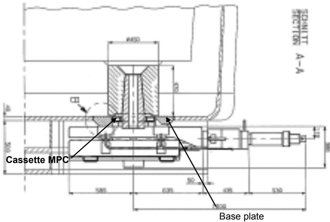
En la figura se observa los porta sensores a ambos lados de la buza interna y en círculo con B la fijación a la placa base .
