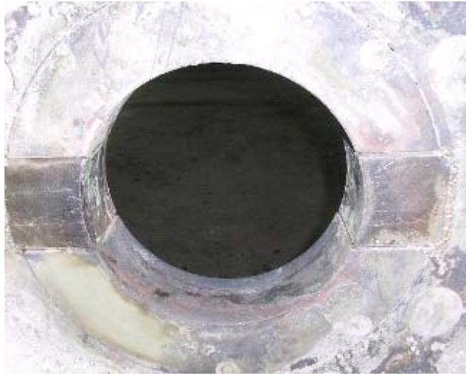
Placa base con segunda campaña de colado, se puede apreciar los porta sensores con más de cuatrocientas coladas sin necesidad de reparar soldaduras de fijación ( tareas de mantenimiento )
