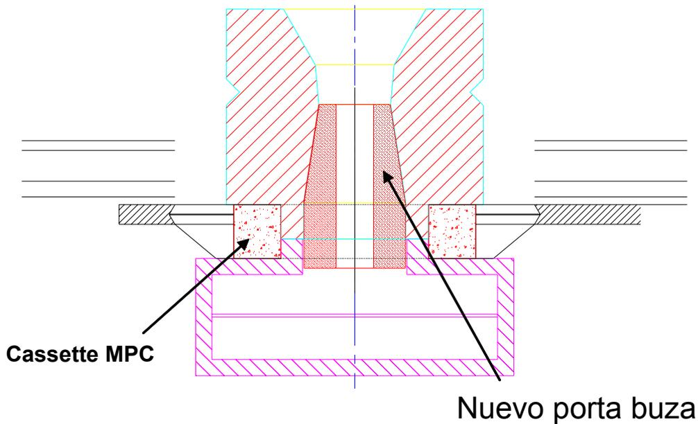
En este dibujo se puede apreciar , la nueva posición de los porta sensores , los mismos se encuentran montados en la placa base , en su nueva posición (89 mm mas alejados de la buza interna ) .
