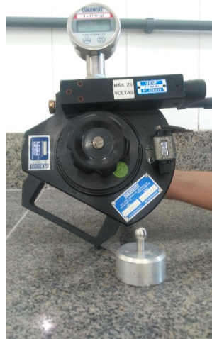
Figura 2. Equipamento utilizado no ensaio de aderência.
