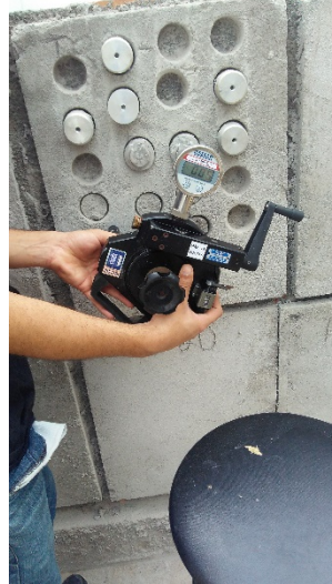
Figura 1. Procedimento de ensaio de aderência.
