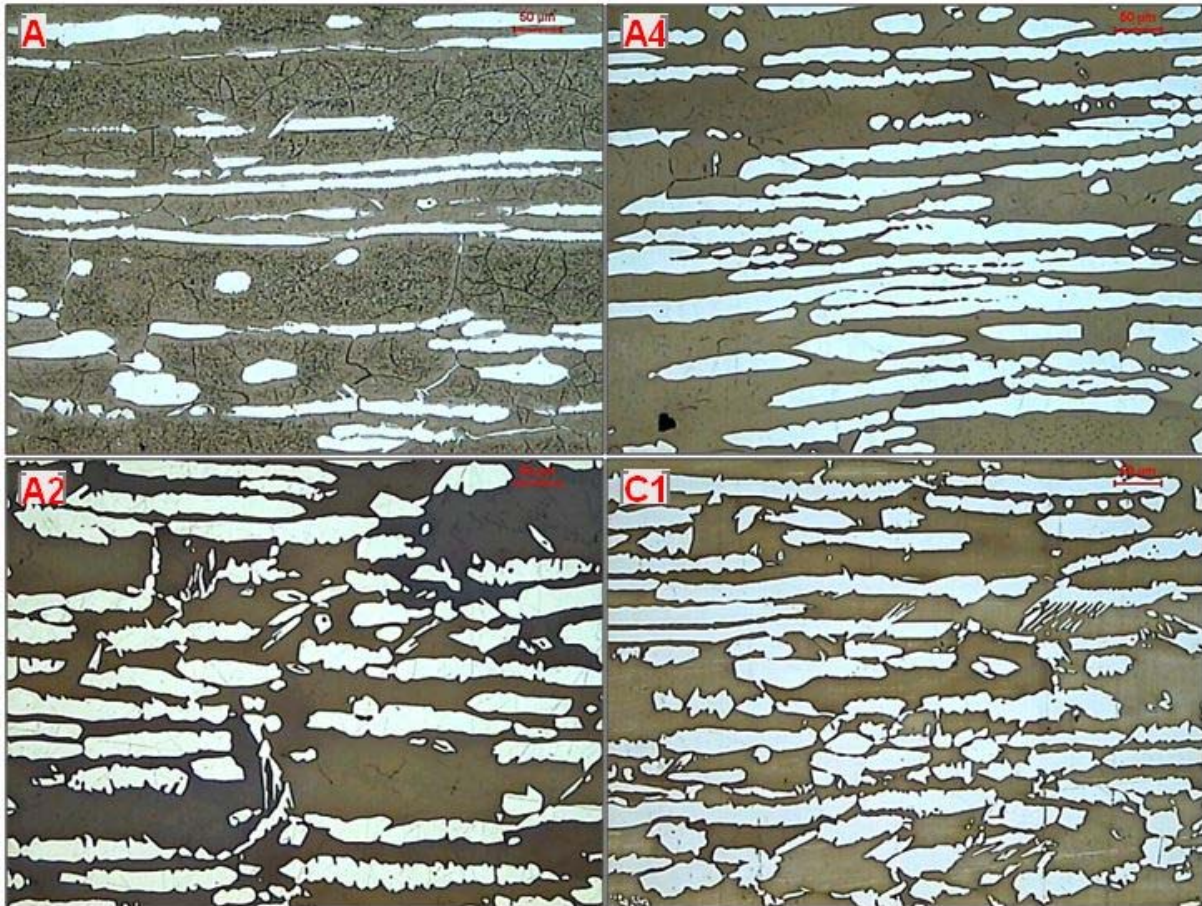
Figura 6: Micrografia das amostras A1, A4, A2 e C1; Ataque Behara II MO – 200x.
