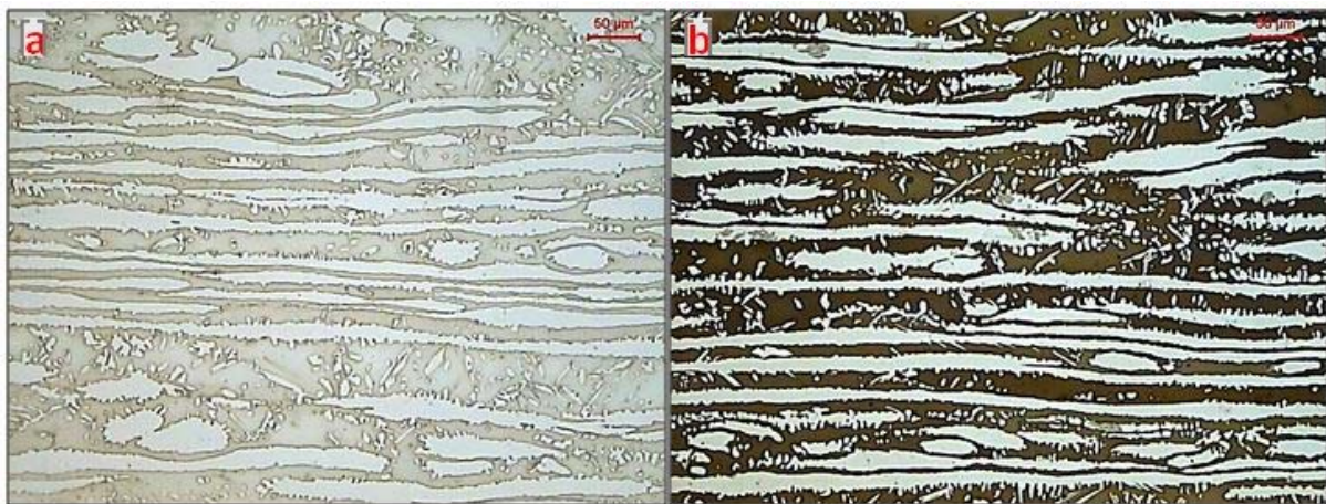
Figura 1 – Micrografia da amostra C4 (a) Ataque eletrolítico com solução aquosa de 10% de KOH; (b) Ataque Behara II – MO – 200x
