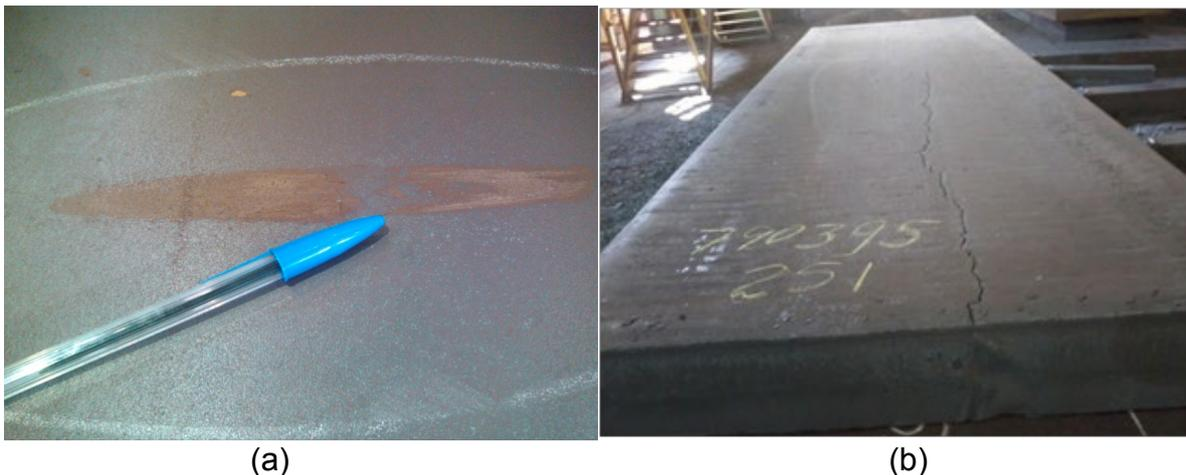
**Figura 1** – Defeitos superficiais - (a). Produto laminado com a presença de defeito associado à inclusão de pó fluxante. (Oliveira [1]); (b) Trinca Longitudinal em placa. (Oliveira [2]).
