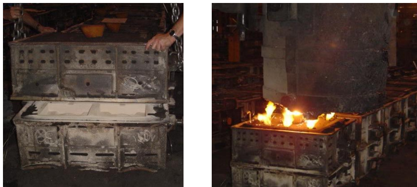
Figura 3. Fechamento do molde e vazamento.
