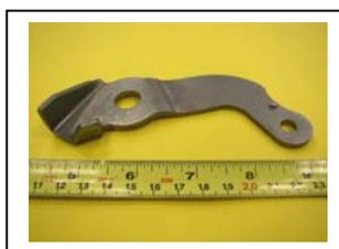
**Figura 2.** Peça em aço SAE 1050
