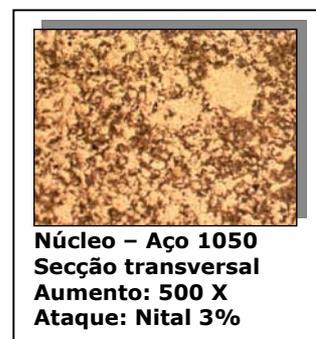
**Figura 8-** Microestrutura do núcleo
