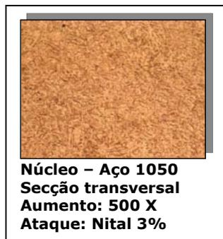
**Figura 7-** Microestrutura do núcleo
