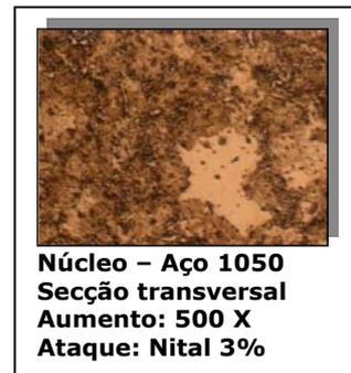
**Figura 6-** Microestrutura do núcleo
