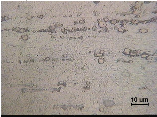
Figura 8. Fio como trefilado com 1,25 mm de diâmetro, 1.000x.
