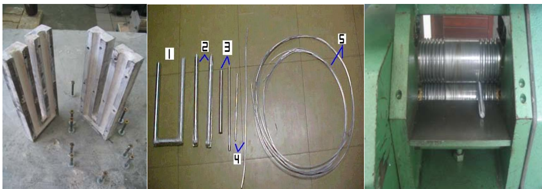
Figura 1. Molde em U, o arranjo seqüencial do processo deformativo ao qual o material foi submetido até o diâmetro final e o laminador com canais circulares.
