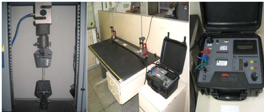
Figura 2. Equipamentos para a Caracterização Mecânica [KRATOS] e Elétrica [Multiohmímetro].
