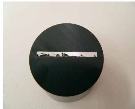
Figura 2. (a) Curva obtida pelo ensaio de polarização cíclica da amostra 1 em 0,01mV/s. (b) Foto representativa da corrosão ocorrida na amostra.
