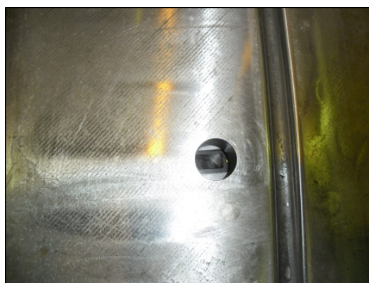
Figura 5. Furo de 23 mm no anel da ferramenta para que o laser e a câmera possam monitorar o escoamento do blank no momento da estampagem.
