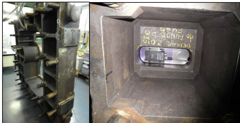
Figura 4. Sensor óptico integrado no anel da ferramenta.
