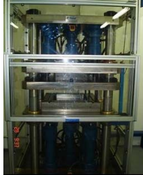
Figura 3: Visão geral da prensa de estampagem ArcelorMittal Vega.
