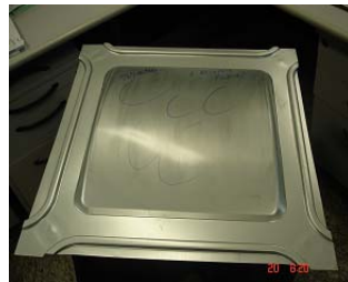
Figura 4: Estampo produzido pela prensa de estampagem ArcelorMittal Vega (500 x 500 mm)
