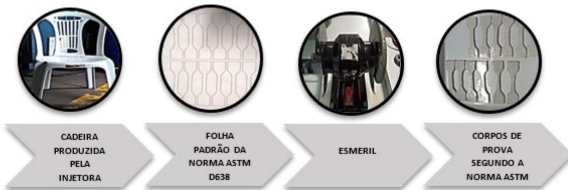
Figura 4. Fluxograma de processo de obtenção de corpos de prova.
