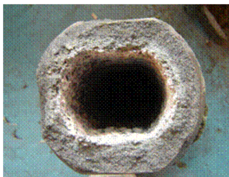
Figura 2: Corte do perfil da válvula na linha de escória com desgaste normal.
