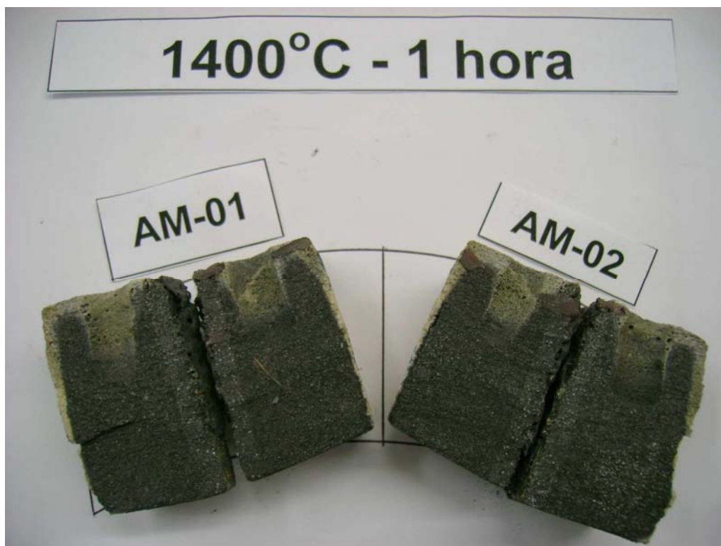
Figura 6: Corte longitudinal dos corpos ensaiados, mostrando a área de reação.
