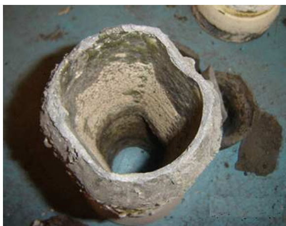
Figura 3: Perfil da válvula após corte horizontal.
