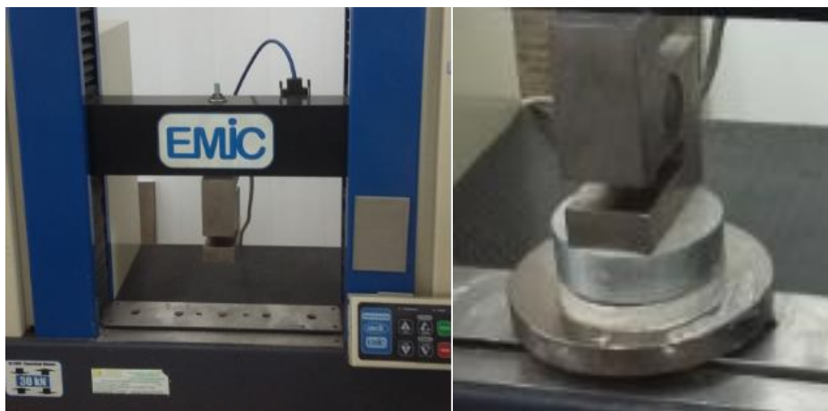
Figura 1. Máquina utilizada e o método squeeze-flow em andamento
