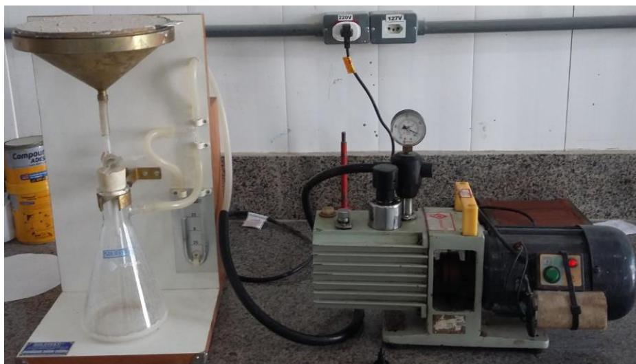
Figura 3. Ensaio em andamento com bomba de vácuo e aparelho de retenção de água
