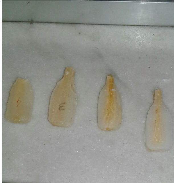
Figura 3. Amostras de compósitos contendo, da esquerda para a direita 0%, 1,5%, 1,5% e 2,5% respectivamente.
