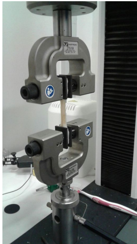
Figura 2. Compósito de epóxi, fibras de fique e surfactante sendo submetido ao ensaio de tração.
