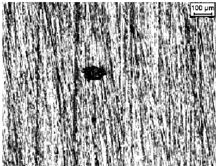
Figura 3. Observação de pite na amostra tratada por 6 horas a 1200°C após 24 horas de imersão em solução 0,6M NaCl.
