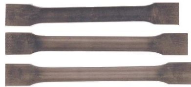
Figura 2. Corpos de prova pré-deformados em tração de 6%, 14% e 20% \varepsilon_{\text{efet}} .
