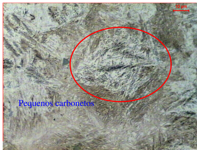
Figura 6: Região de carbonetos dispersos presentes na estrutura
