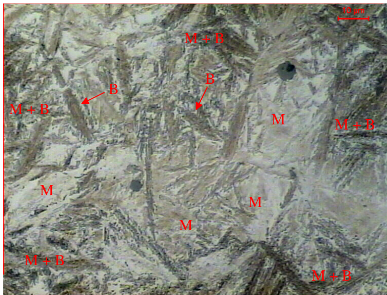
Figura 3: Estrutura do aço baixa-liga tratado e resfriado ao ar forçado
