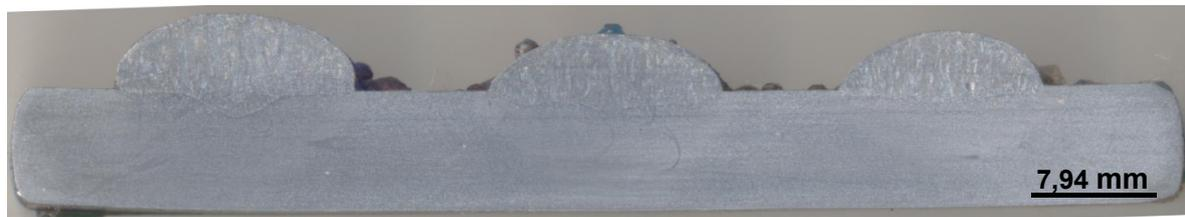
**Figura 9.** Secção transversal dos cordões depositados pelo processo GMAW-CW 70% para uma velocidade de soldagem de  $3,67 \times 10^{-3}$  m/s.<sup>(5)</sup>
