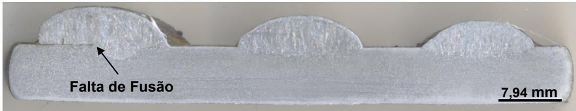
**Figura 8.** Secção transversal dos cordões depositados pelo processo GMAW-CW 60% para uma velocidade de soldagem de  $3,33 \times 10^{-3}$  m/s.<sup>(5)</sup>
