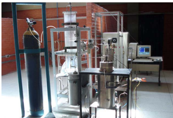
Figura 6. Instalação para estudos de Corrosão sob Tensão.
