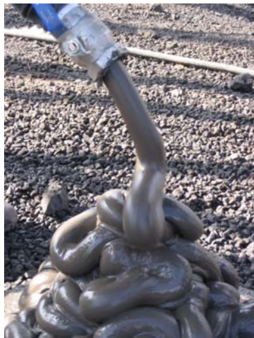
Figura 10. Pasta gerada de rejeito de minério de ferro.
