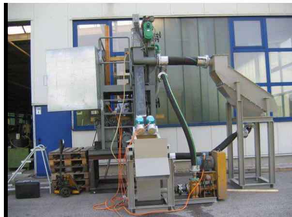
Figura 2 – Jigue pneumático piloto utilizado nos testes.
