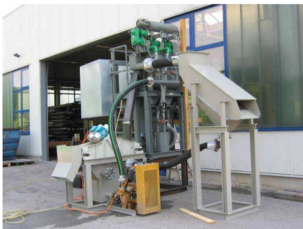
Figura 2 – Jigue pneumático piloto utilizado nos testes.
