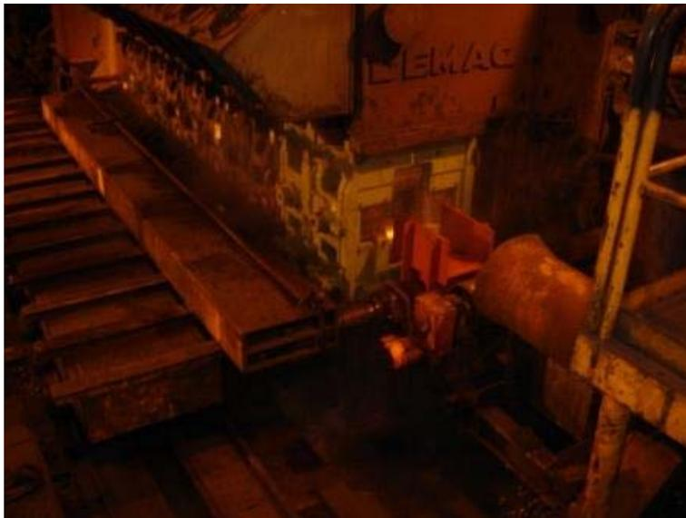
**Figura 14.** Laminador Calibrador – adaptado para laminação de perfis.
