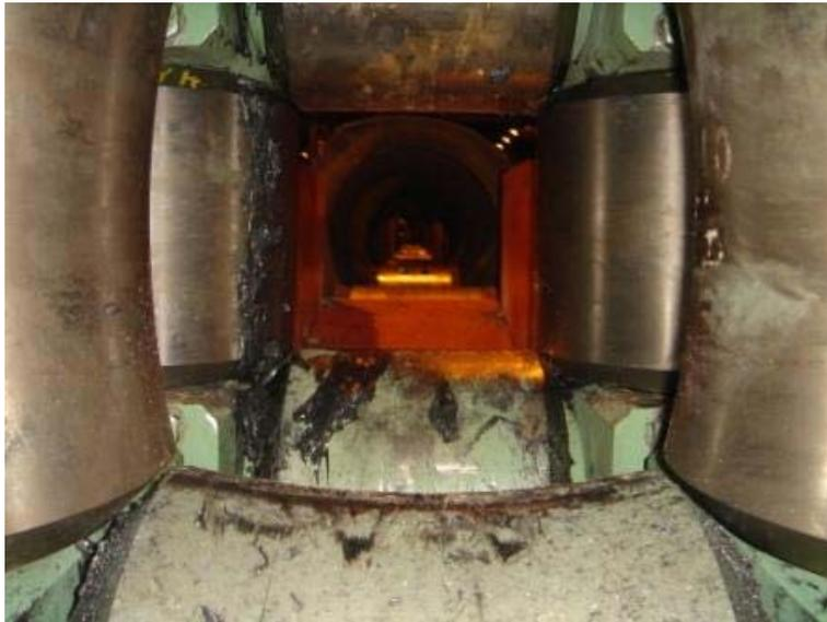
**Figura 13.** Visão do alinhamento da saída do Laminador Calibrador.
