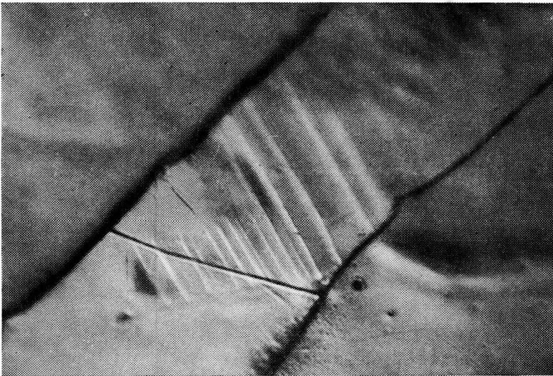
Fig. 2 — Linhas finas paralelas num grão da fase  $\epsilon$  da liga Cu — 31,51% Sb. Eletro-polido por  $\text{HNO}_3$  (1) +  $\text{CH}_3\text{COOH}$  (2) e percutido em nitrogênio líquido. Aumento:  $\times 2000$ .
