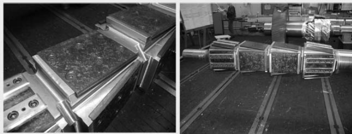
Figura 8 : Eixo de bobinadeira com liners de composto de fibra de carbono.
