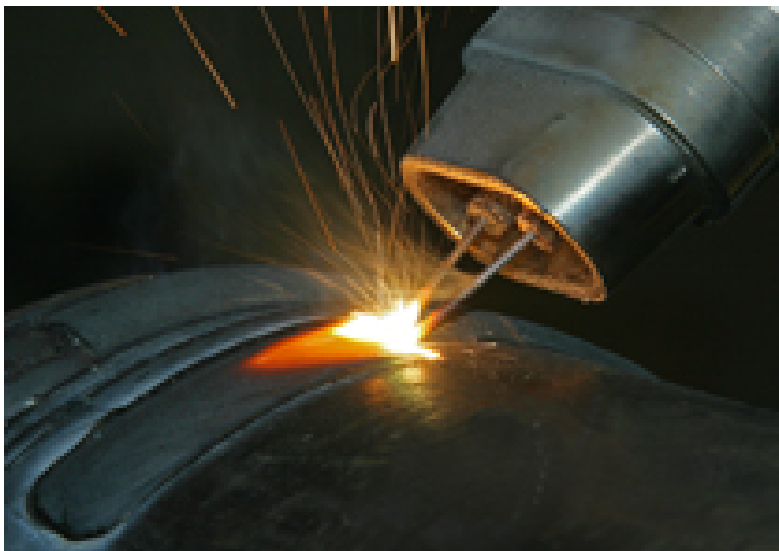
Figura 9 : Revestimento com solda a laser.
